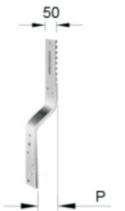
Parte verticale per support"TORINO" Vertical Arm for Torino Supports,Z shaped(reverse) Z型反向端支架
