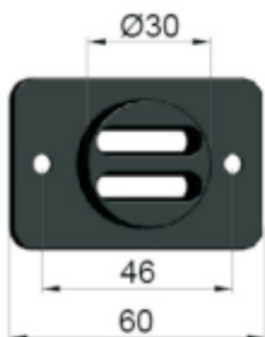
Guidacinghia trasversale in pladtica per Omega Waagerechte Gurtführung aus Kunststoff FÜR OMEGA Horizontal plastic strap guide for Omega OMEGA 用双扁导口 (横式)
